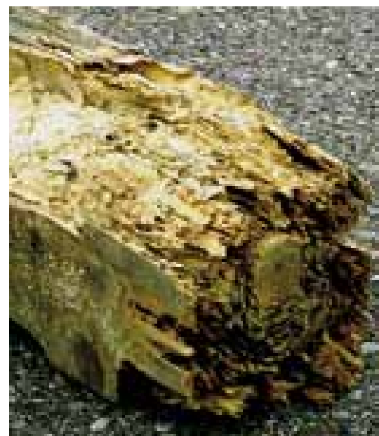
Bild 13 Fraßgänge des Echten Hausbocks im Nadel Splintholz
