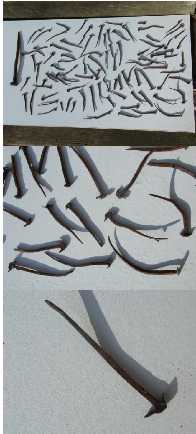
Handgeschmiedete Nägel in der 200 Jahre alten Verbretterung der Sägemühle
